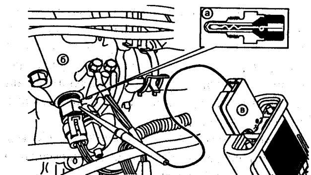
Рис. 1. Датчик температуры охлаждающей жидкости на двигателе автомобиля
