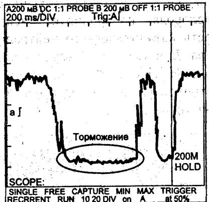
Рис. 6. Выходные сигналы датчика кислорода в различных режимах
