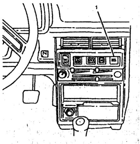
Рис. 1. Пример размещения индикатора CHECK ENGINE (отмечен цифрой 1)
