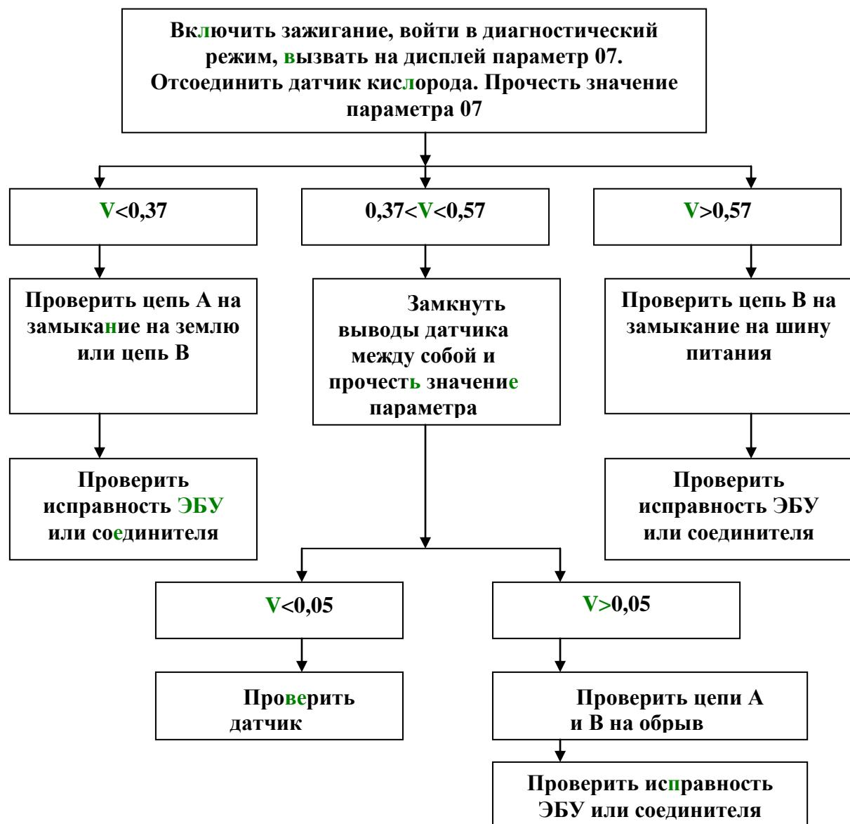
Рис. 4. Диагностическая карта для кода 13 (датчик кислорода не готов)
