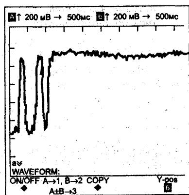
Рис. 7. Выходной сигнал датчика кислорода при подаче пропана
