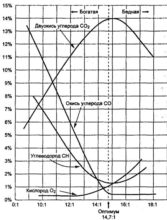
**Рис. 1. Состав выхлопных газов в зависимости от соотношения воздух/топливо в смеси**
