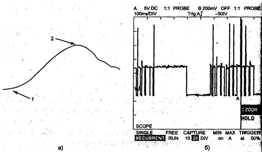
Рис. 11. Осциллографмы сигнала датчика положения клапана EGR (а) и напряжения на обмотке соленоида (б): 1 — клапан закрыт; 2 — клапан открыт
