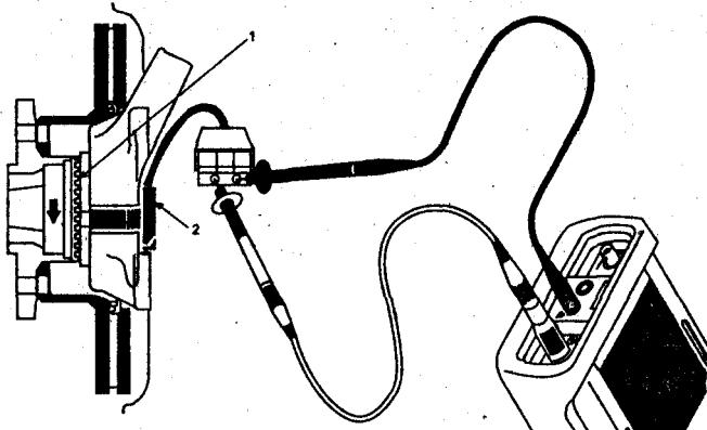
Рис. 14. Проверка датчика скорости АБС с помощью осциллографа:
