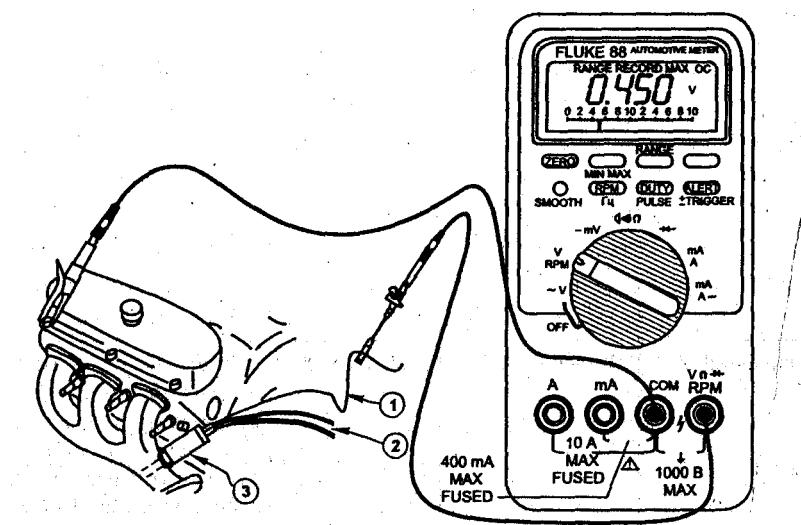
Рис. 4. Подключение мультиметра к датчику кислорода: 1 — сигнальный провод; 2 — провода нагревателя; 3 — датчик
