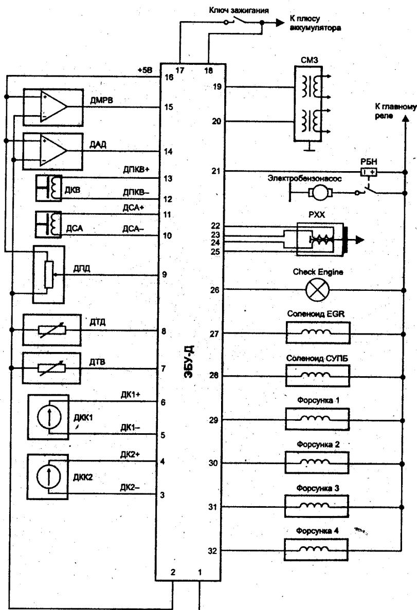
Рис. 2. Электрическая схема системы управления двигателем автомобиля
