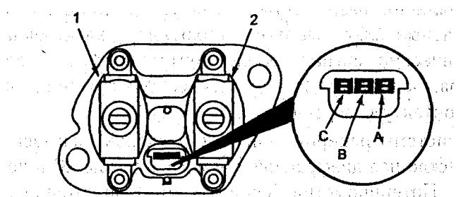
Рис. 12. Цифровой клапан с двумя отверстиями:
