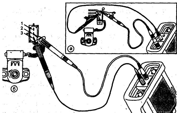
**Рис. 2. Проверка датчика положения дроссельной заслонки:**
