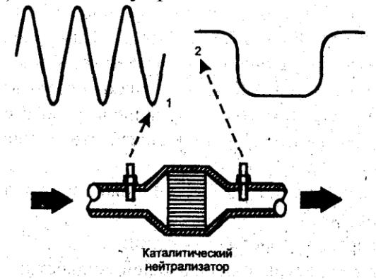
Рис. 1. Датчики кислорода на входе (1) и выходе (2) каталитического нейтрализатора с соответствующими выходными сигналами
