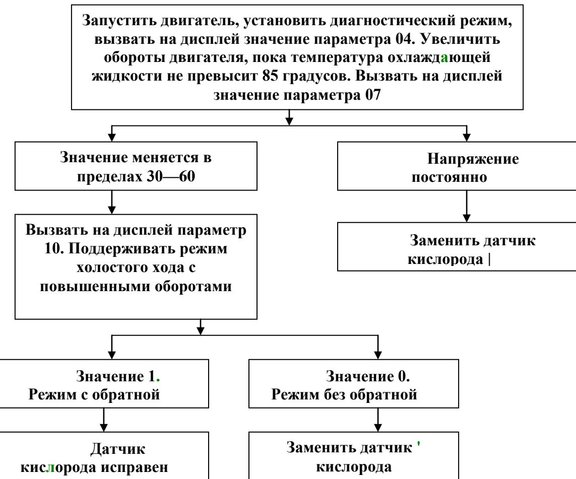
**Рис. 5. Проверка работоспособности датчика кислорода**
