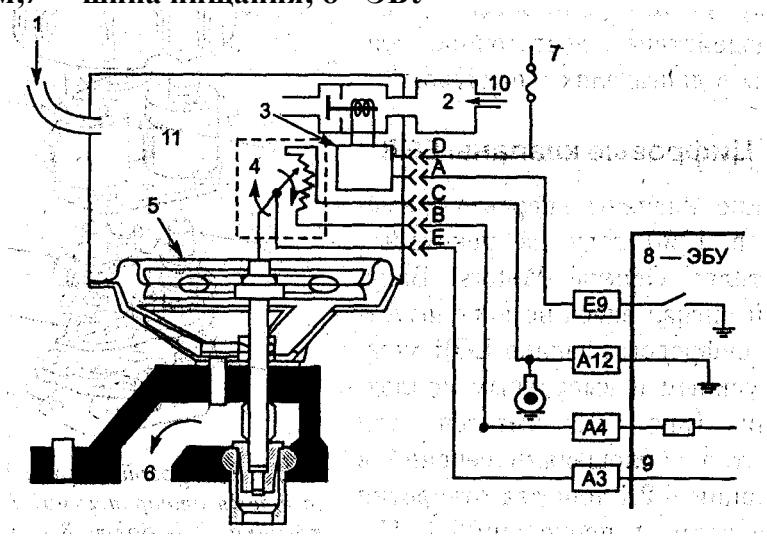
**Рис. 8. Клапан EGR с управлением по утечке разрежения:** 1 — ввод разрежения в воздушный фильтр для подачи атмосферного воздуха; 3— электроклапан; 4 -датчик положения клапана EGR 8— диафрагма; 6— поток выхлопных газов на выходе клапана EGR; 7 шина питания; 8 — ЭБУ; 9 — сигнал включения злектроклапа;O<sub>2</sub> — атмосферный воздух; 11 – вакуумная камера.
