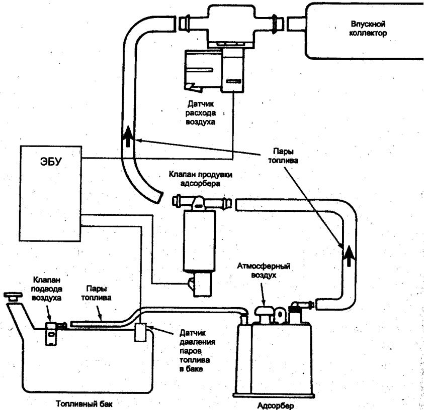
**Рис. 5. Схема улавливания паров топлива в баке**
