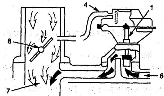
Рис 2. Вариант подключения EGR
