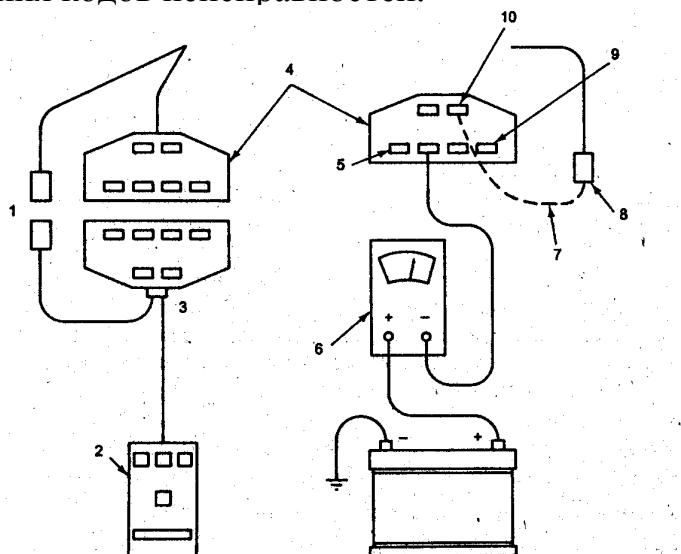
Рис. 6. Считывание кодов неисправностей на автомобилях Рога с помощью сканера или вольтметра. 1 и 8 — разъемы для запуска режима самотестирования, 2 — специализированный тестер-сканер STAR, 3 — разъем сканера, 4 — диагностический разъем автомобиля. 5 — сигнал с тахометра (на некоторых моделях). 6 — стрелочный вольтметр, 7 — перемычка, 9 — сигнал от реле бензонасоса, 10 — контакт №2
