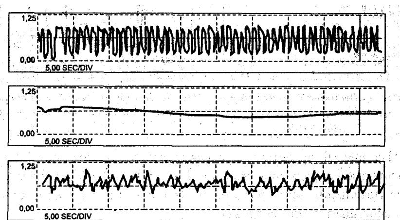
**Рис. 9. Сигнал первого датчика кислорода на входе каталитического нейтрализатора (вверху); сигнал второго датчика кислорода на выходе эффективного (исправного) каталитического нейтрализатора (в середине) и сигнал второго датчика кислорода на выходе неэффективного (засоренного) каталитического нейтрализатора (внизу)**
