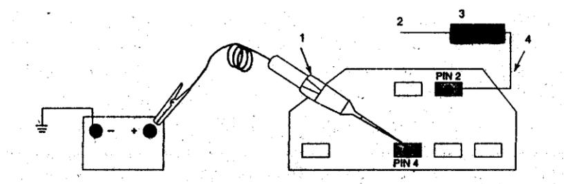
**Рис. 7. Считывание кодов ошибок на автомобилях Ford с помощью контрольной лампы.** 1 — контрольная лампа; 2 — проводот ЭБУ; 3 — разъем для запуска режима самотестирования; 4 — диагностический разъем; 5 — перемычка
