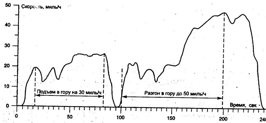
**Рис. 3. Маршрут теста IM240 для испытуемого автомобиля**
