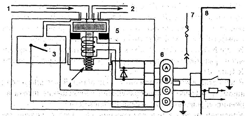
**Рис. 7. Электропневмоклапан с управлением по принципу широтно-импульсной модуляции:** 1 — вакуумная линия к клапану £0'К; <? -т, линия к источнику разрежения; 3 — диагностический нормально разомкнутый вакуумный ключ; 4 — запорная пружина; 5 — Нормально закрытый пружиной 4 и обесточенный электроклапан; 6 — рабьем; 7— шина питания; 8 - ЭБУ
