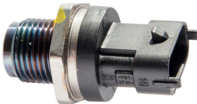
Рисунок 28 – Датчик давления в аккумуляторе системы Common Rail
